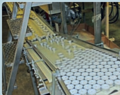
PILDIL ON TEEKÜÜNLAPRESSLIIN, MIS KASUTAB TOORAINEKSI PARAFIINIPULBRI, ERINEVALT 2006. A SÜGISSEL KÄIVITATUD TEEKÜÜNLAVALIINIST, MIS KASUTAB PARAFIINIST ODAVAMAT PALMIVAHA.
