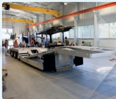
VEOAUTODE JA ERITEHNIKA VEOKS MÕELDUD TT 70, MIS KOOSTEHALLIS OSTJA JÄRELETULEMIST OOTAB, MAHUTAB NÄITEKS KOLM SADULAUTOT VÕI KAKS SUURT TRAKTORIT.
