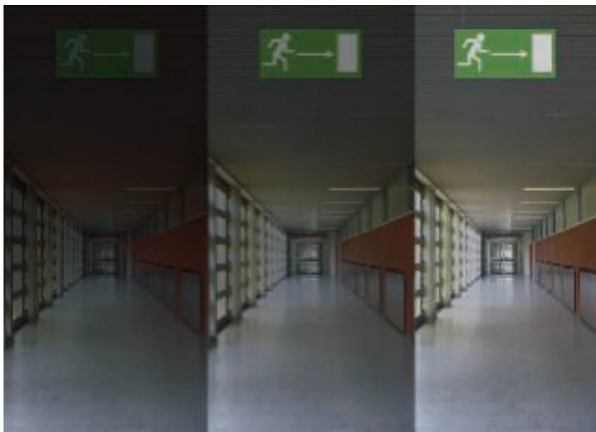
Kaablite käitumine tulekahju korral: PVC –isolatsiooniga, vähe-suitsevad, halogeenivabad (alates vasakult)
