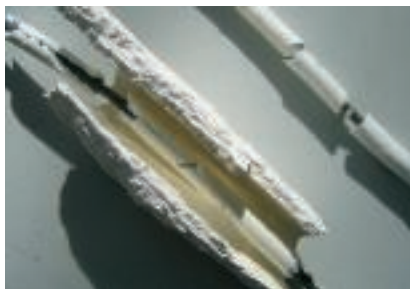
Funktsiooni tagav kaabel isoleeriva tuhakihiga
