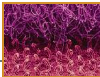
Värviline elektronmikrograafi pilt kokku vajutatud VELCRO® kinnitusribadest. © Dee Breger, Drexel University.
