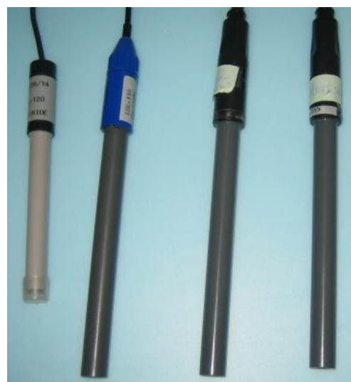
в) Ионселективные электроды для определения \text{Cl}^- , \text{Ca}^{2+} , \text{NH}_4^+ , \text{NO}_3^-
