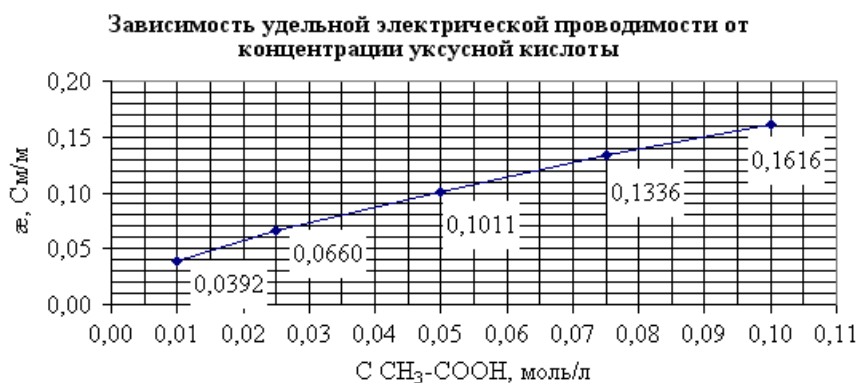
Рис. 2.9. Зависимость удельной электрической проводимости растворов уксусной кислоты от ее концентрации в растворе.
