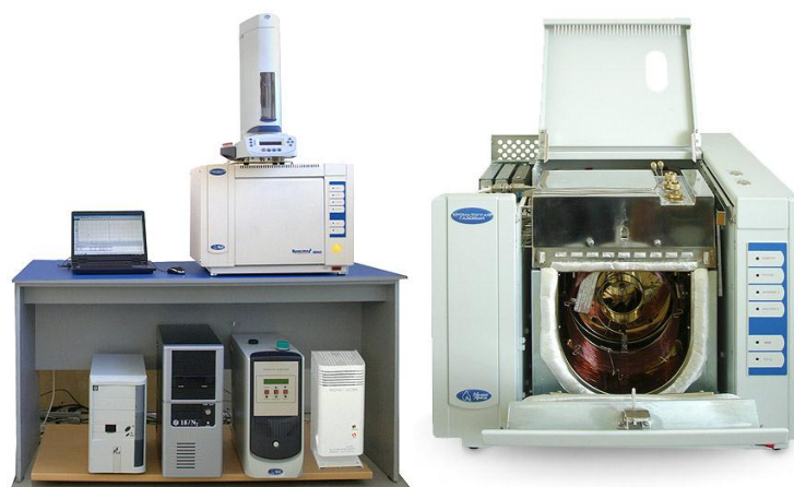
Рис.4.22. Газовый хроматограф «Кристаллюкс-4000М», его термостат с капиллярной колонкой
