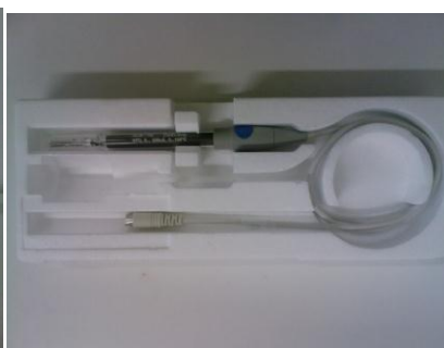
Кондуктометрический электрод MettlerToledo для измерения удельных электрических проводимостей в интервале 0 ÷ 500 мкСм/см.
