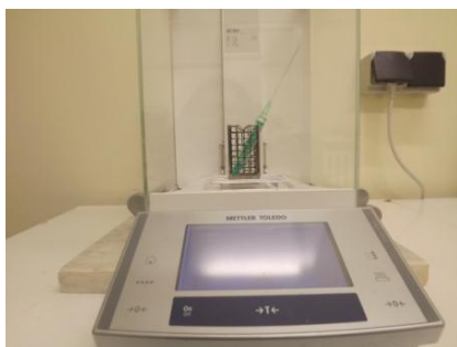
Рис. 2.28. Взвешивание в специальном контейнере на аналитических весах отобранного шприцем образца топлива для его анализа на влагосодержание.
