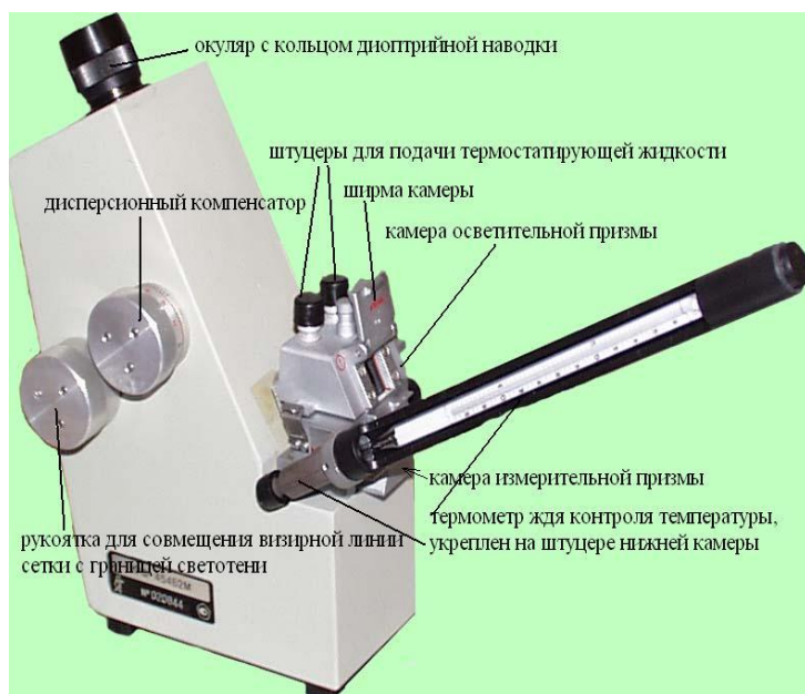
Рис. 5.10. Устройство лабораторного рефрактометра ИРФ-454Б.
