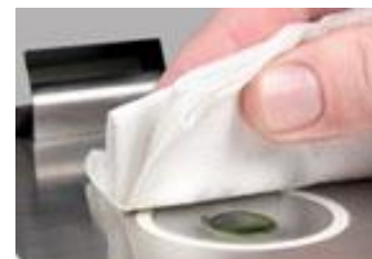
Рис. 5.19. Очищение призмы рефрактометра по окончании работы на нем.
