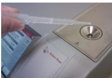
Рис. 5.18. Нанесение исследуемого раствора на измерительную призму рефрактометра Abbe 550.
