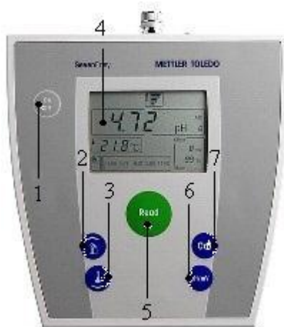
Рис. 2.50. Устройство и назначение клавиш потенциометра Seven Easy S20 Mettler Toledo.
