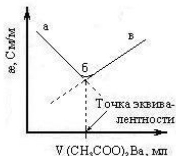
Рис. 2.11. Кондуктометрическое титрование сульфата натрия ацетатом бария.
