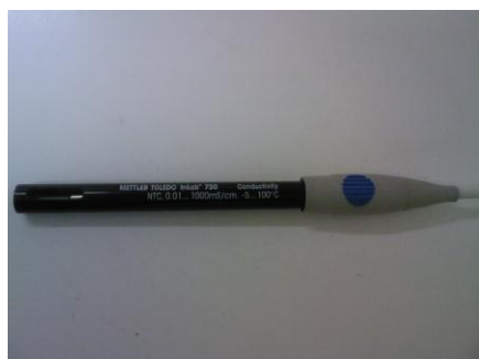
Кондуктометрический электрод MettlerToledo для измерения удельных электрических проводимостей в интервале 0,01 ÷ 1000 мСм/см.
