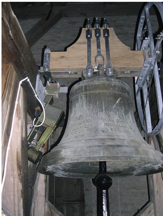
48. Колокол с электрическим механизмом. Фото: Т. Мязяли
