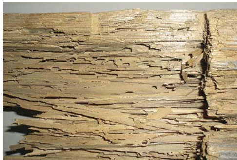
60. Древесина, изнутри поврежденная насекомыми. Фото: У. Каллавус
