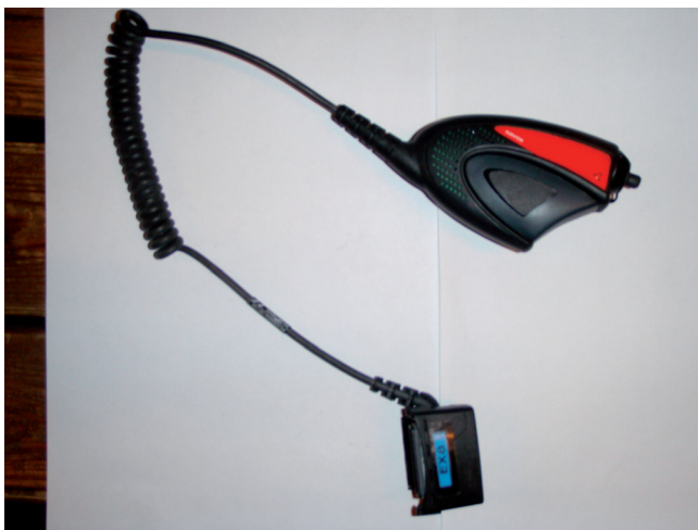
Joonis 25. Ex – kindel monofon, mis kinnitatakse tulekustutusriietuse krae külge, suule ja kõrvale võimalikult lähedale. Eeliseks on suur saatelemineku nupp, mida on võimalik ka kinnastes raskusteta vajutada. Miinuseks kõlari heli tavalisest tagasihoidlikum kuuldavus.
