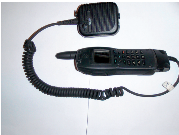
Joonis 24. Monofon, mis kinnitatakse tulekustusriietuse krae külge, suule ja kõrvale võimalikult lähedale. Miinuseks on väike saatelemineku nupp, mida on problemaatiline kinnastes vajutada
