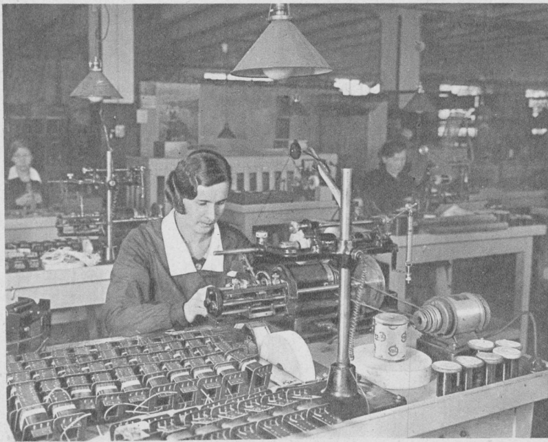
Transformātoru spoļu tinēja darbā Transformatoren Spulen-Wicklerin bei der Arbeit
