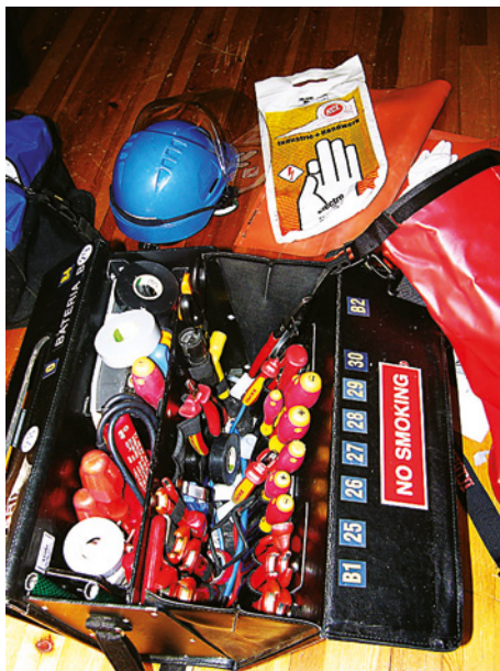
Pilt 32.16. Pingealuste tööde tegemine võib nõuda kohvritäit isoleertööriistu.
