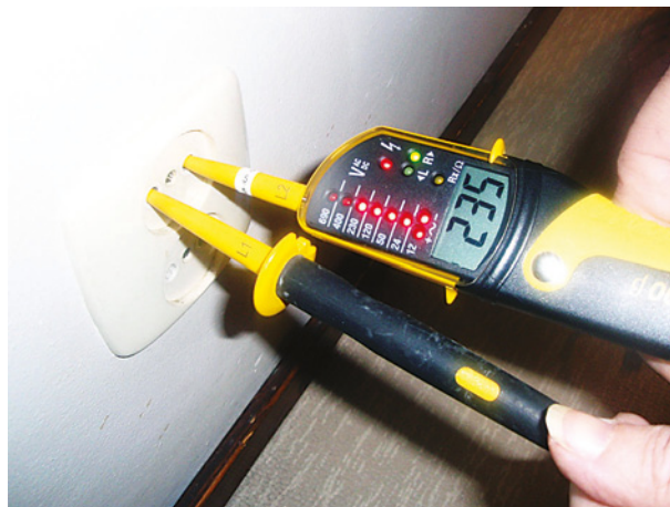
Joonis 32.7. Pingeindikaatori testimine pingestatud ahelatel.
