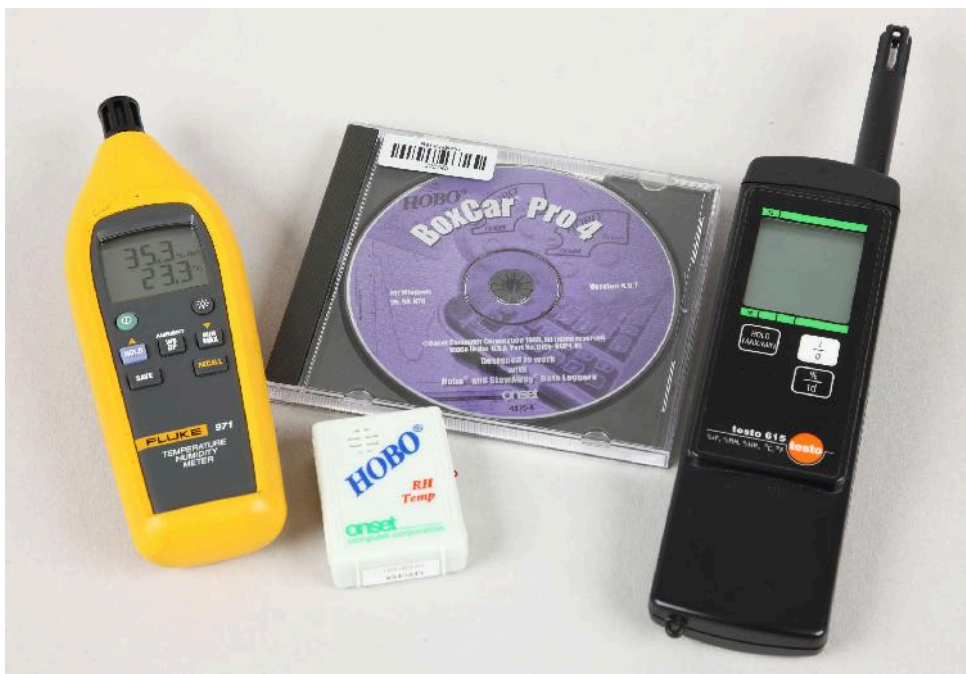
ILLUSTRATSIOON 4. Portatiivsed termohügromeetrid ja logger koos tarkvaraga (pildi keskel)
