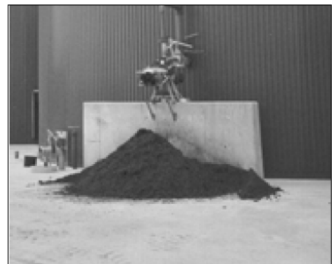
Joonis 3-40: Tiguseparaator; joonis: FAN separaator GmbH; foto: PlanET Energietechnik.
