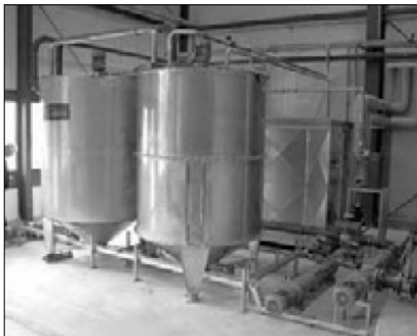
Joonis 3-16: Pastöriseerimine koos jahutamise, foto: TEWE Elektronik GmbH.
