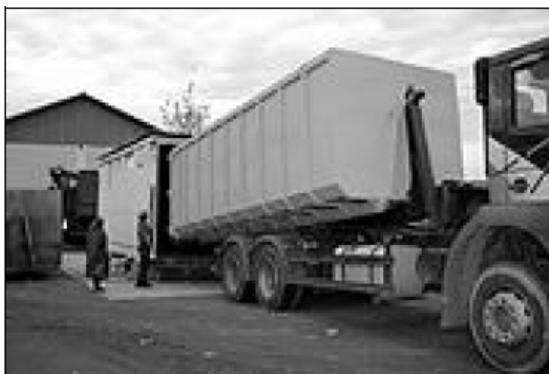
Joonis 3-9: Sisselükatav kuivkäätuskamber (konteiner rullikutel), prototüübi staadiumis, foto Bioferm GmbH.
