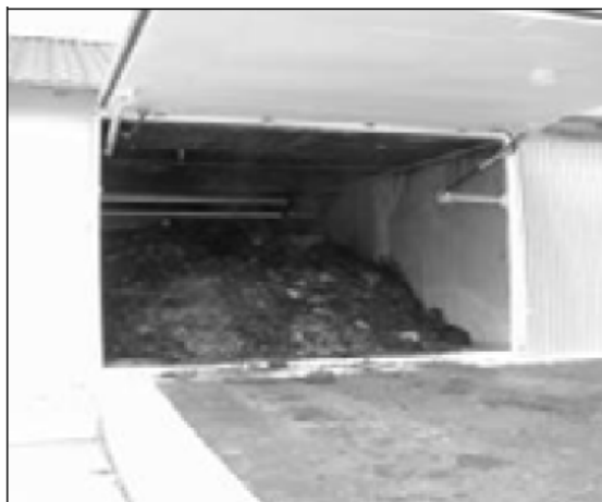
Joonis 3-10: Bokskäätuskamber täitmisel, prototüübi staadiumis. Foto Bioferm GmbH.
