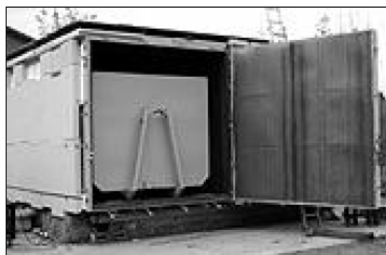
Joonis 3-9: Sisselükatav kuivkäätuskamber (konteiner rullikutel), prototüübi staadiumis, foto Bioferm GmbH.
